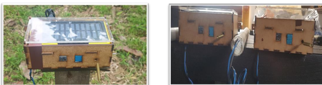
Figura 2-3: Nodo sensor con cargador solar (izquierda), nodos sensor funcionales (derecha).
