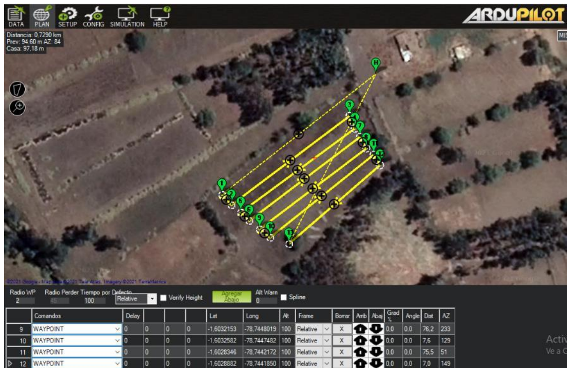
Figura 13-3: Toma de muestras del campo por el UAV.
