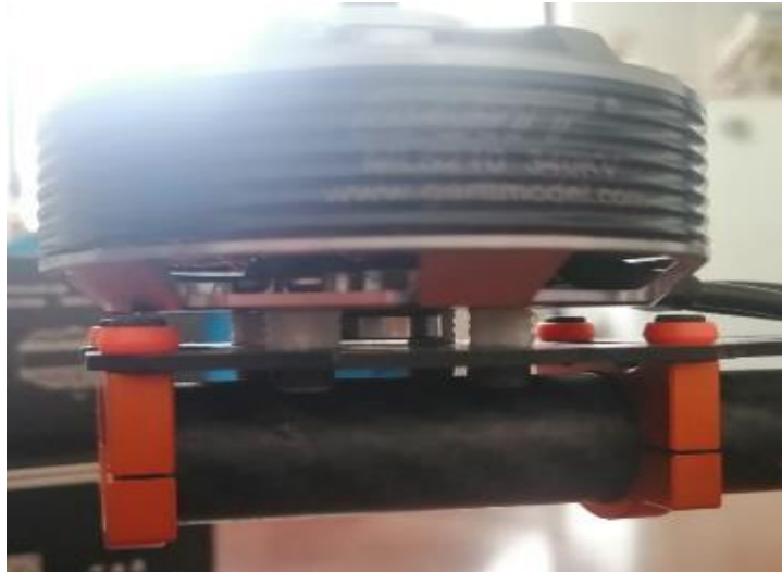
Figura 18-2: Motor fijado con bases para motor impresas en 3D.
