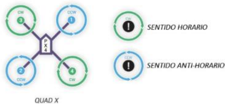
Figura 17a-1: Configuración en X del UAV.
