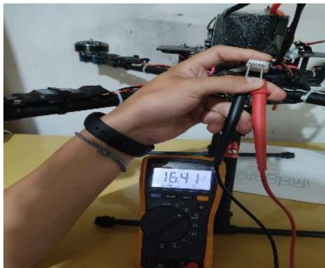
Figura 2-3: Medición de voltaje de las celdas de la batería Zop power lipo .
