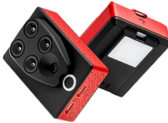
Figura 1-1: Cámara multiespectral Parrot Sequoia+
