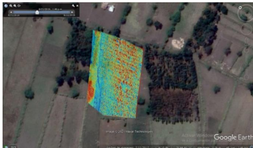
Figura 23-3: Georreferenciación del índice NDVI en Google Earth.
