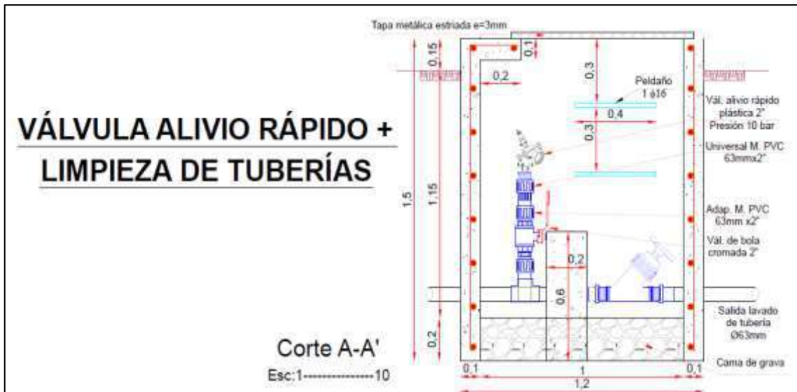
Figura 13-5. Válvula de alivio rápido
