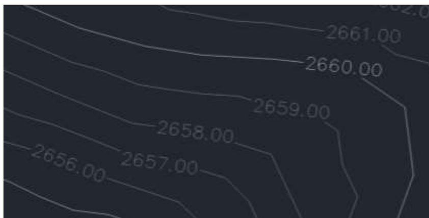
Figura 3-4. Curvas de nivel a cada metro de distancia, obtenida a partir de un modelo Digital del Terreno (MDT).
