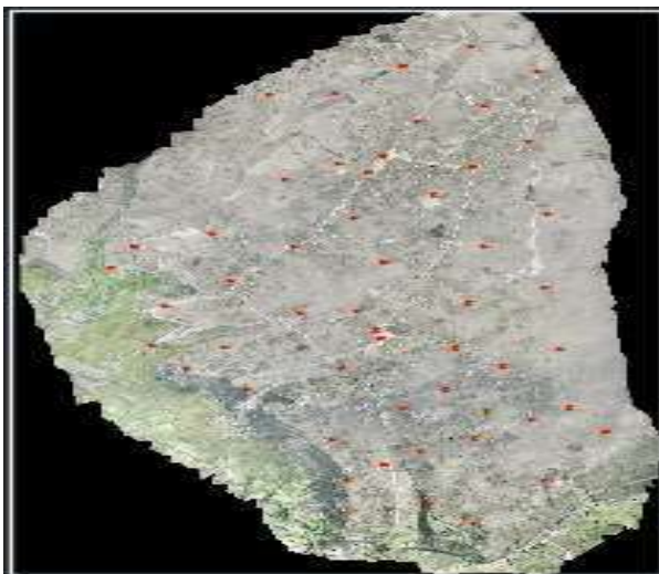
Figura 2-4. Ortofoto de la comunidad Chingazos y los puntos de control representados con color rojo.
