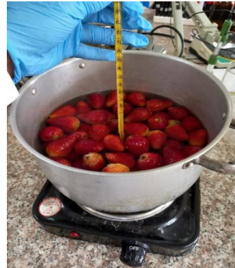
Gráfico 2F. Inactivación enzimática de la fresa.
