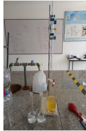
Ilustración 3E. Titulación del Peso Equivalente
