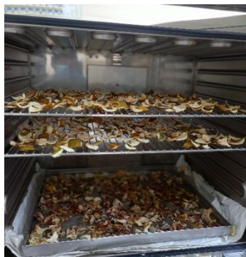
Ilustración 3B. Secado de los residuos de naranja a 70 °C, durante 24 horas hasta un 10 % de humedad.
