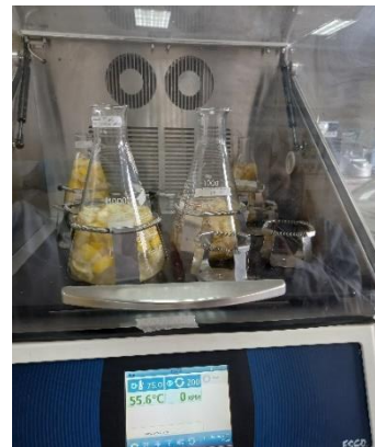
Ilustración 3C. Hidrólisis acida en el equipo SHAKER.
