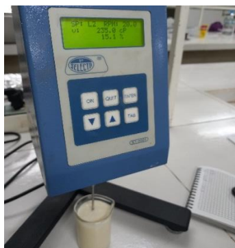
Ilustración 5G. Viscosidad del helado con pectina.
