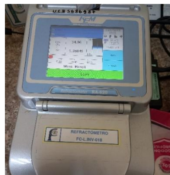
Ilustración 6G. Grados Brix del helado.
