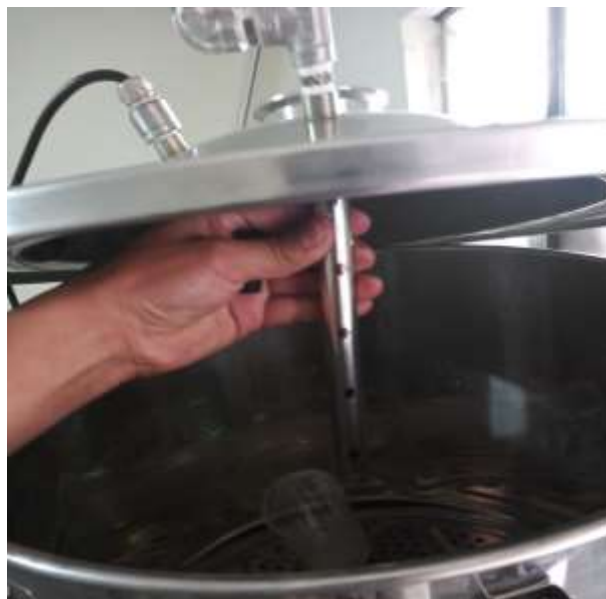
Ilustración 3-35: Sistema de medición de temperatura
