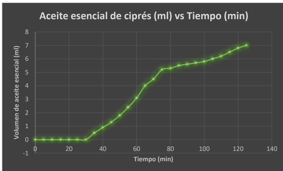
Ilustración 4-10: Curva de extracción de aceite de ciprés para 4 Kg de materia prima.
