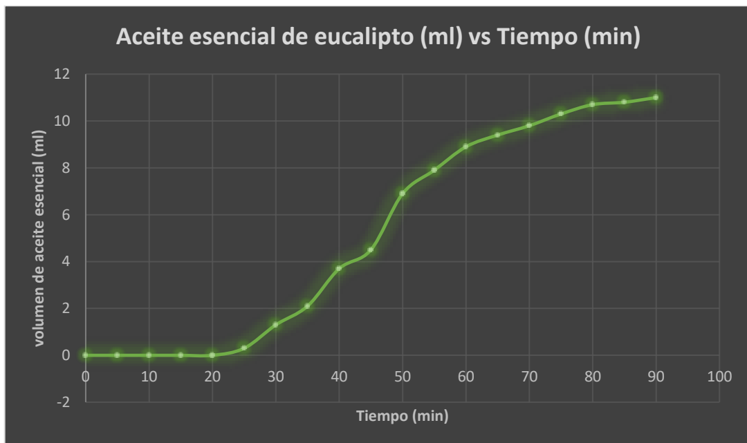
Ilustración 4-4: Curva de extracción de aceite esencial de eucalipto para 2 Kg de materia prima.
