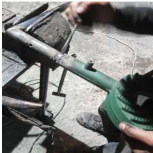
Ilustración 3-49: adaptación de la hornilla del GLP.
