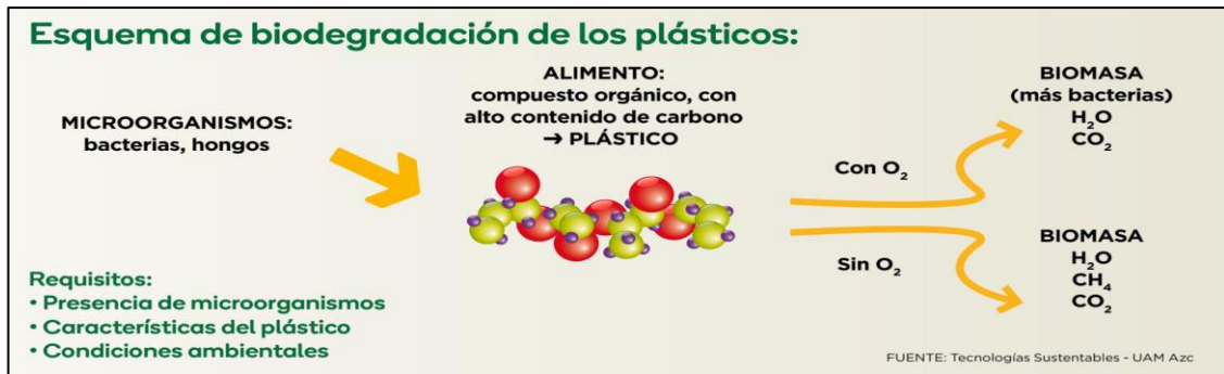
Figura 2-12: Esquema de la biodegradación del plástico biodegradable
