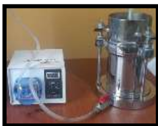
Columna de adsorción de lecho fijo
