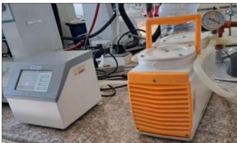
**Ilustración 3-6:** Bomba de vacío BIOBASE VC100 (GM-1 0P).
