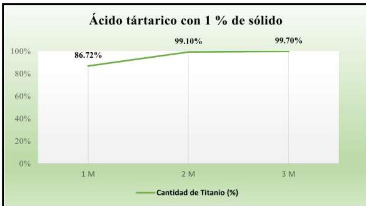
**Ilustración 4-13:** Porcentaje de recuperación de Ti con ácido tartárico a 1, 2 y 3 M con 1 % de sólido.
