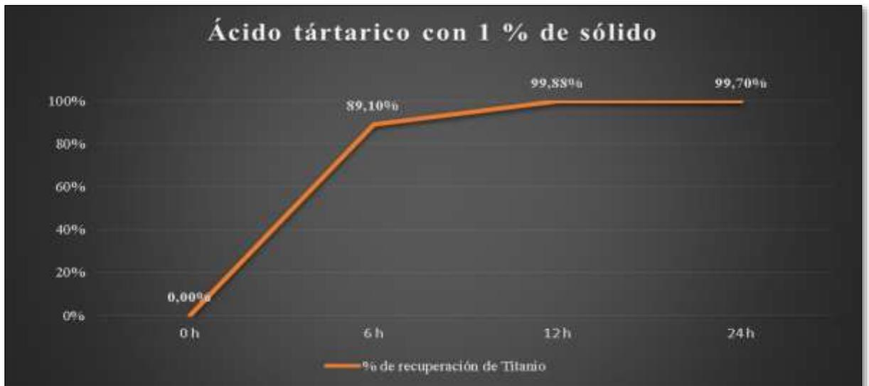
**Ilustración 4-14:** Porcentaje de recuperación Ti con ácido tartárico a 3 M con 1 % de sólido en 6, 12 y 24 horas.
