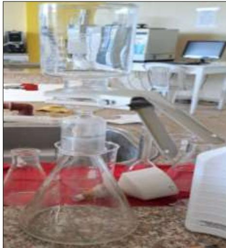
**Ilustración 3-4:** Equipo de filtración.
