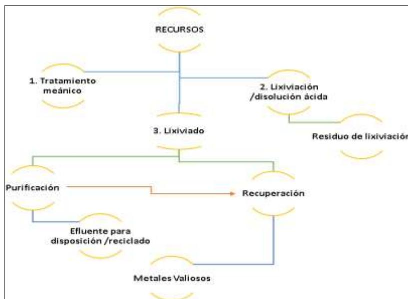
**Ilustración 2-4:** Proceso hidrometalúrgico general.
