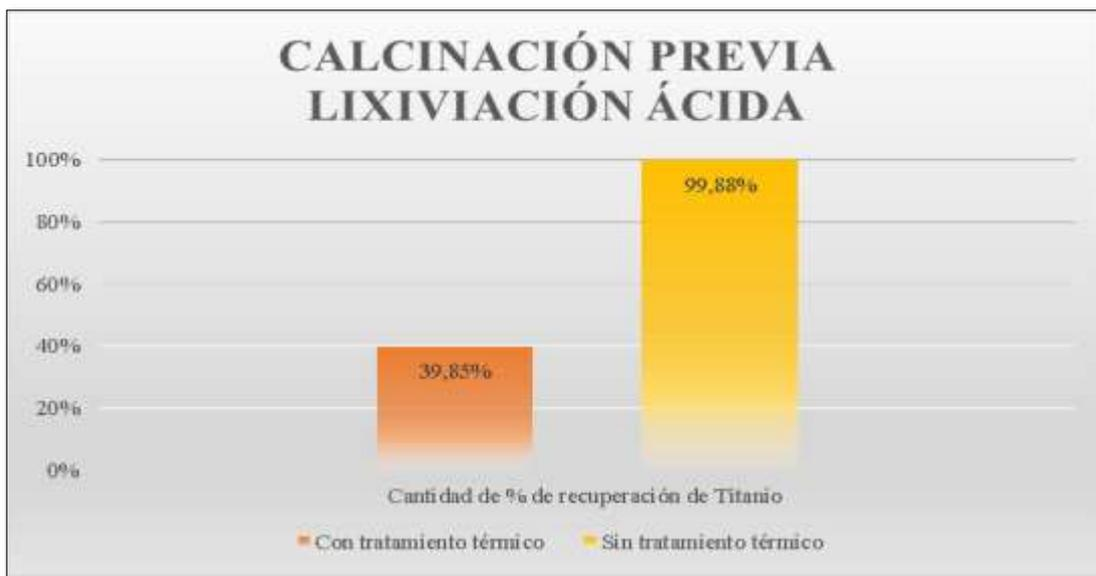
**Ilustración 4-16:** Porcentaje de recuperación Ti con ácido tartárico a 3 M con 1 % de sólido en 12 h, con y sin tratamiento térmico.
