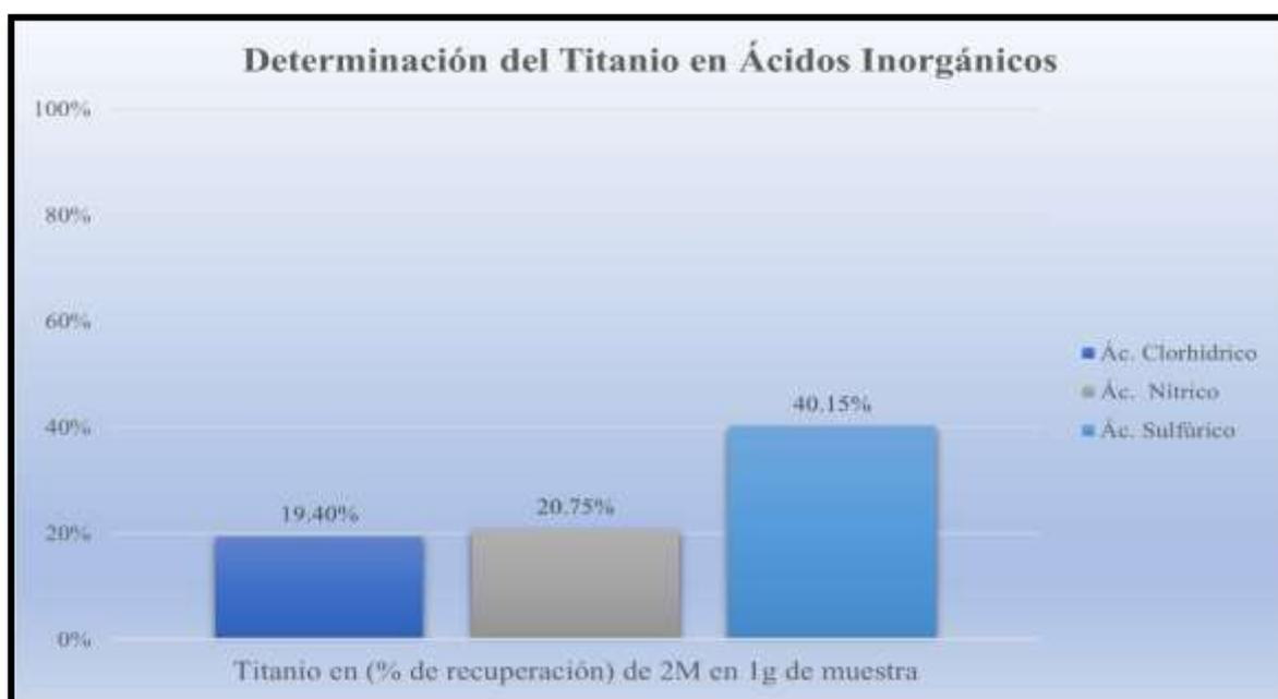
**Ilustración 4-4:** Recuperación de Ti con lixiviación ácida de HCl, HNO<sub>3</sub>, H<sub>2</sub>SO<sub>4</sub> a 2 M, 24H y 1 % de sólidos.
