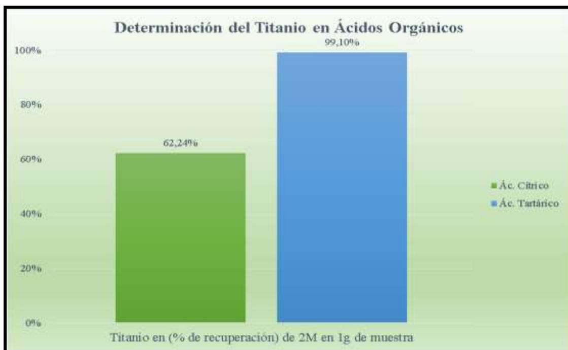
**Ilustración 4-9:** Recuperación de Ti con lixiviación ácida del  $\text{C}_6\text{H}_8\text{O}_7$  y  $\text{C}_4\text{H}_6\text{O}_6$  a 2 M, 24h y 1% de sólidos.
