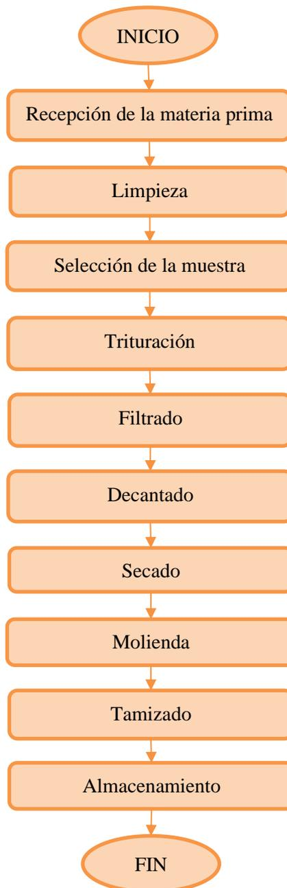
**Ilustración 2-3:** Diagrama de flujo del proceso de obtención del almidón de yuca.
