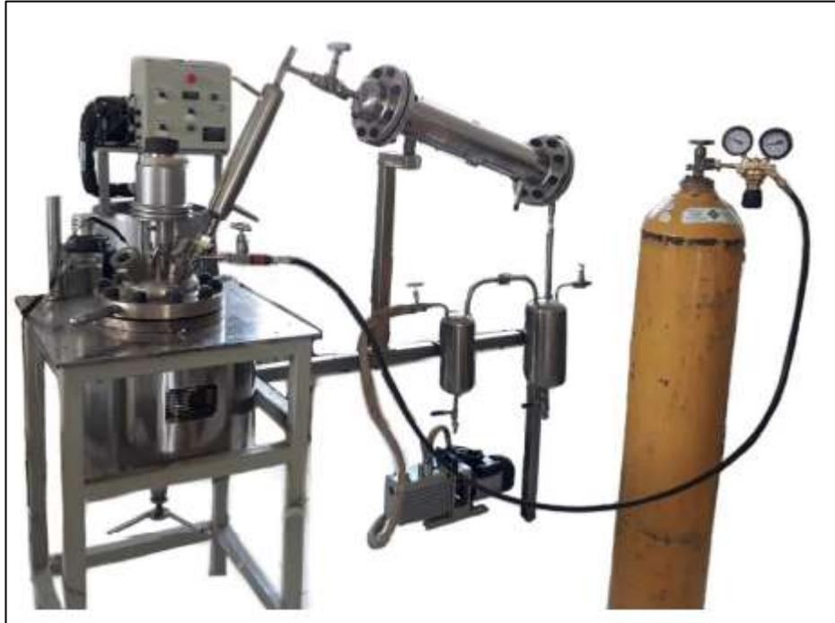
**Ilustración 2-2:** Esquema de la Unidad de reacción
