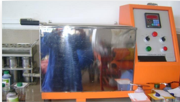
Foto N.- 6 Máquina de Preblanqueo
