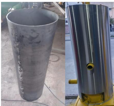
**Ilustración 12-3:** Cilindro A36 y cilindro AISI 430
