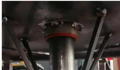
**Ilustración 11-3:** Mecanismo para variar el volumen de la cámara de reducción
