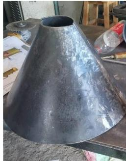
**Ilustración 7-3:** Cámara de combustión
