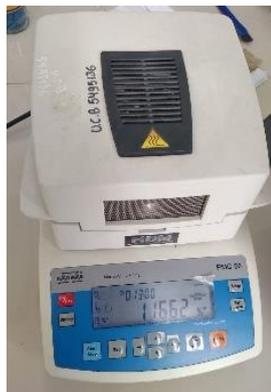
**Ilustración 1-3:** Termobalanza RADWAG
