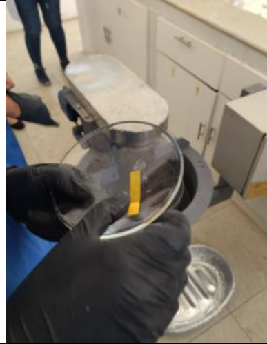
Proceder a medir el pH de la pulpa
