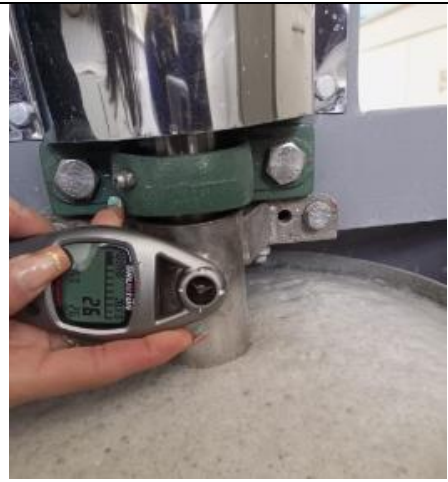
Medir el flujo de aire con el anemómetro
