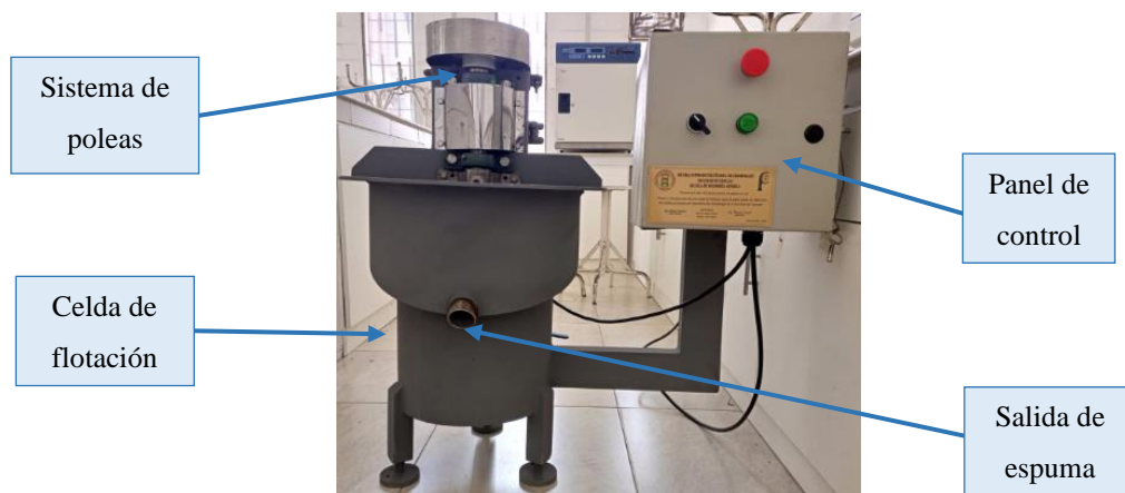
Ilustración 1-4: Celda de flotación parte frontal
