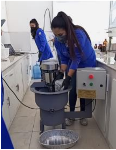
Colocar 3 kgr de muestra y encender el equipo
