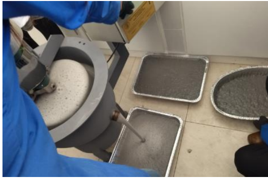
Recolectar las espumas en bandejas y llevar a la estufa
