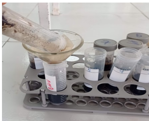
Figura 17: Centrifugación y filtración para determinar CE y Ph
