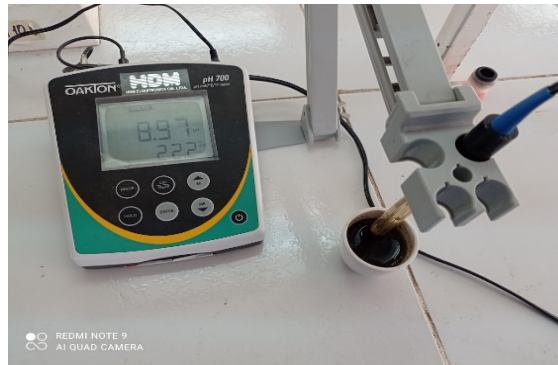
Figura 18: Determinación de pH y CE
