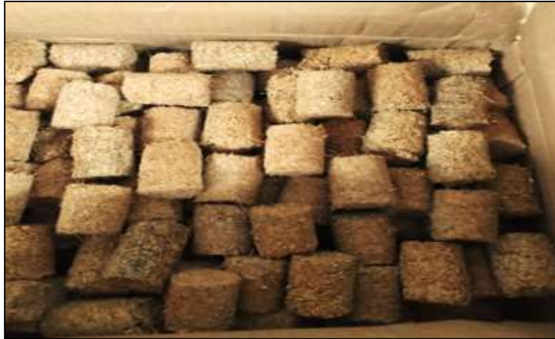
Ilustración 15-4: Briquetas óptimas 6 Bar y 80 °C
