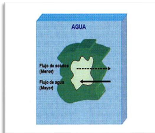
**FIGURA No. 4 TRANSFERENCIA DE MATERIA OCURRIDA DURANTE LA REHIDRATACIÓN DE UN ALIMENTO DESHIDRATADO**
