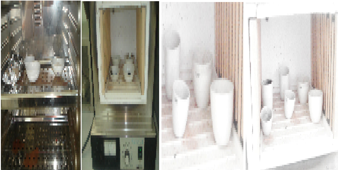
FOTOGRAFÍA N° 6. ANÁLISIS FÍSICO-QUÍMICO DEL FRUTO DE LA TUNA, EL ORDEN DE LAS DETERMINACIONES DE IZQUIERDA A DERECHA SON: % HUMEDAD, % CENIZAS TOTALES, % CENIZAS SOLUBLES EN AGUA, Y % CENIZAS INSOLUBLES EN AGUA.
