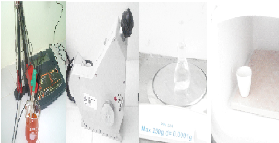
FOTOGRAFÍA N° 7. ANÁLISIS FÍSICO-QUÍMICO DEL EXTRACTO AL 100% DEL FRUTO DE LA TUNA, EL ORDEN DE LOS ANÁLISIS DE IZQUIERDA A DERECHA SON: DETERMINACIÓN DEL pH, ÍNDICE DE REFRACCIÓN Y GRADOS BRIX, DENSIDAD Y SÓLIDOS TOTALES.
