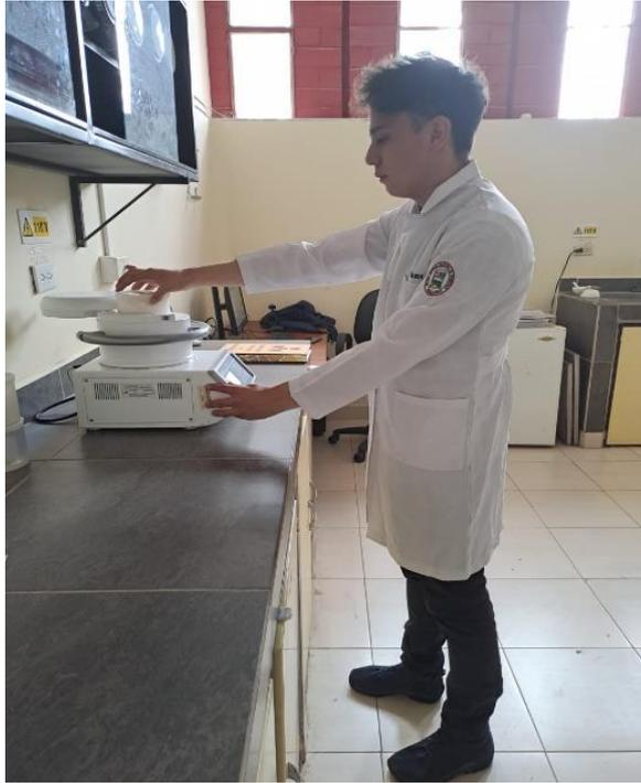
**Ilustración 2-13:** Análisis de muestras en el espectrómetro ADANI Rug 91-2
