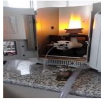
Equipo espectrofotómetro de absorción atómica de llama para medir concentración de metales.
