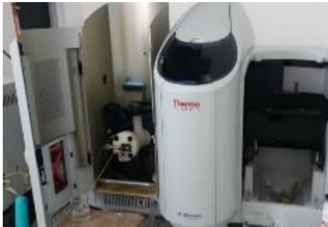
Equipo espectrofotómetro de absorción atómica de llama para medir concentración de metales.
