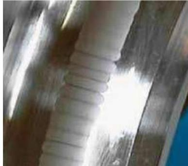
**Ilustración 2-13:** Erosión por fuga de corriente
