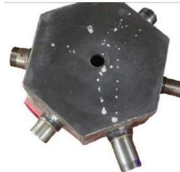
**Ilustración 4-6:** Colocación de los ejes en el hexágono
