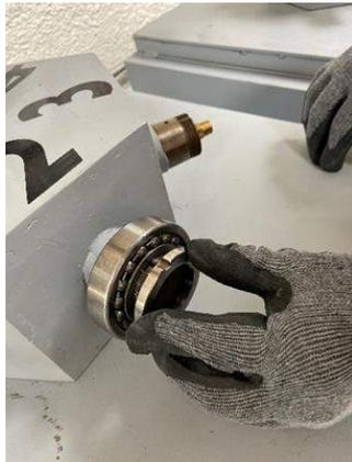
**Ilustración 4-7:** Pre-sujeción del rodamiento.
