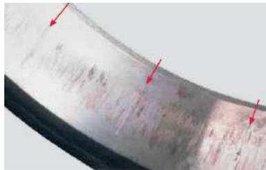
**Ilustración 2-11:** Corrosión por fricción
