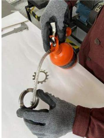
**Ilustración 1-6:** Lubricación de la rosca de apriete.
