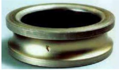
**Ilustración 2-6:** Fatiga iniciada en la superficie
