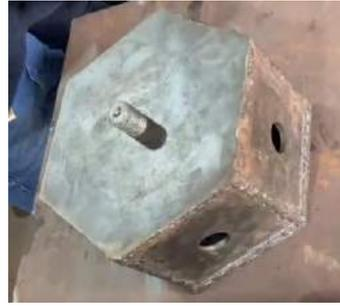
**Ilustración 4-4:** Construcción del hexágono
