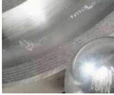
**Ilustración 2-12:** Erosión eléctrica
