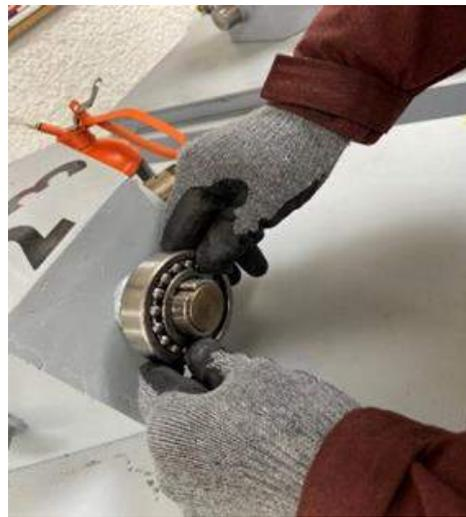
**Ilustración 4-5:** Montaje del rodamiento 1208K
