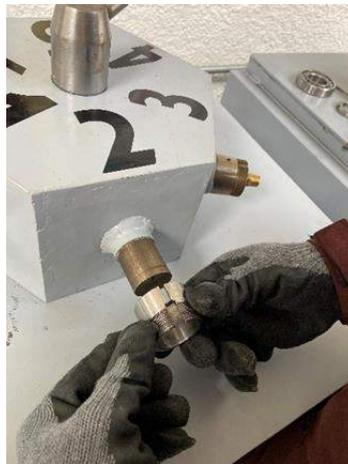
**Ilustración4-13:** Desmontaje del manguito de fijación.
