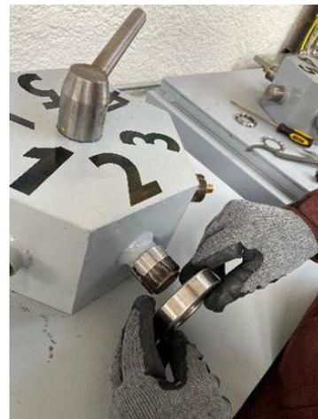
**Ilustración4-14:** Desmontaje del rodamiento 1208K.
