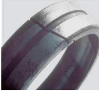
**Ilustración 2-17:** Fractura por fatiga
