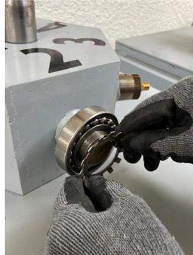
**Ilustración 4-9:** Colocación de la arandela de traba.
