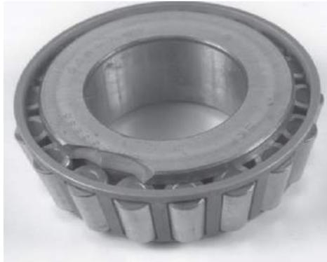
**Ilustración 2-16:** Fracturas y agrietamiento
