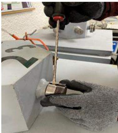
**Ilustración 4-4:** Montaje del manguito de fijación.
