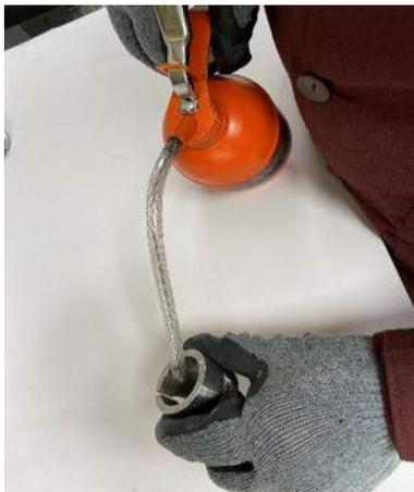
**Ilustración 4-3:** Lubricación del manguito de fijación.
