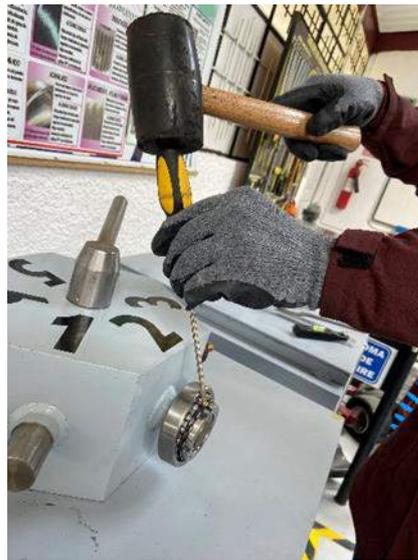
**Ilustración 4-10:** Fijación de la arandela de traba.
