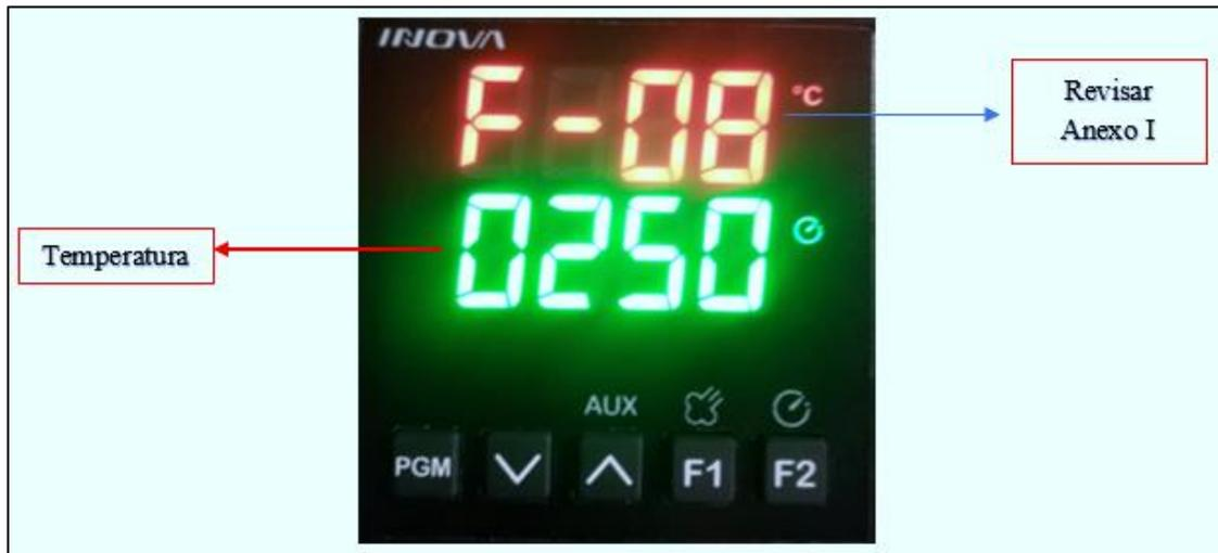
**Ilustración 17-3:** Temperatura máxima de trabajo
