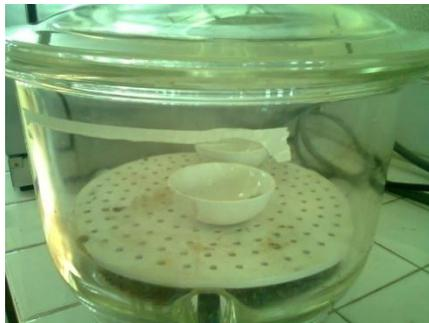
**FOTOGRAFÍA No. 6 Desecadora y cápsulas**
