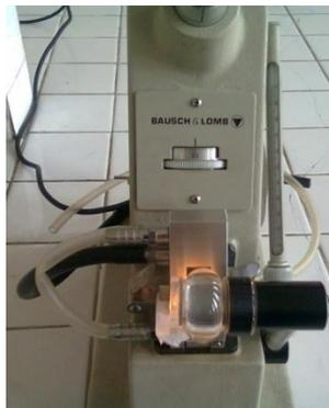
**FOTOGRAFÍA No. 12 Refractómetro de Abbe**
