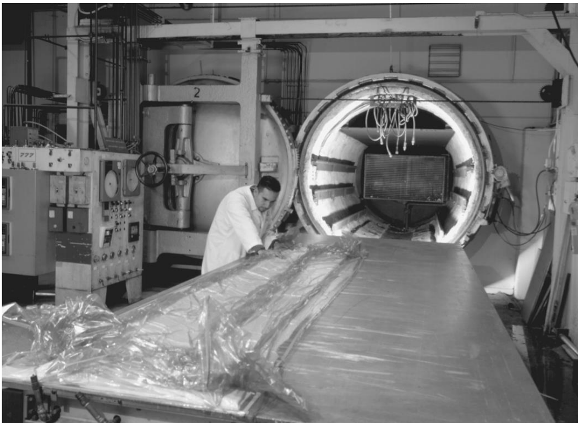
Figura 33-2. Pieza aeroespacial envasada al vacío lista para entrar en autoclave.
