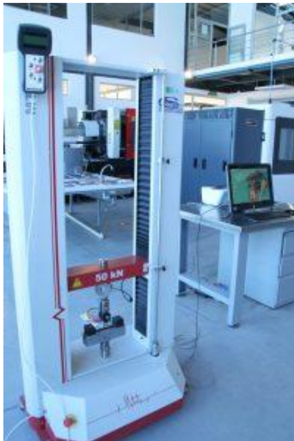
Figura 28-2. Metrotec Serie MTE50. Máquina de ensayos universales de hasta 50 KN para materiales poliméricos, cerámicos, compuestos y metales ligeros.
