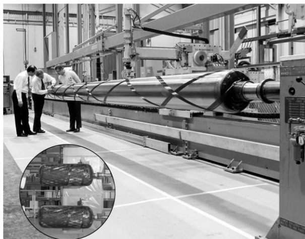
Figura 36-2. Demostración del tendido de fibras en un mandril.
