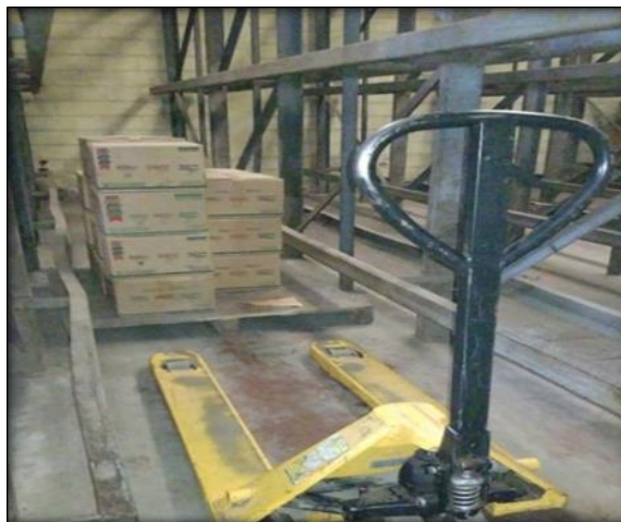
Figura 10-4: Transpaleta utilizada para el almacenaje
