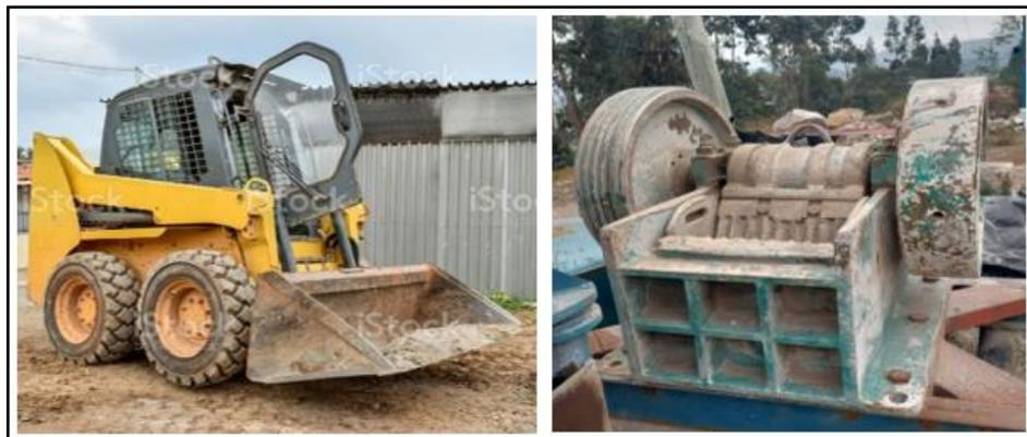
**Figura 5-4:** Retroexcavadora pequeña y Trituradora de mandíbulas primario.
