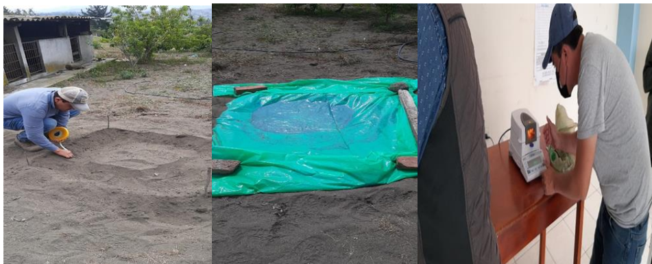
Figura 2-3: Metodología para determinar capacidad de campo (CC) y el punto de marchitez permanente (PMP) en el suelo.
