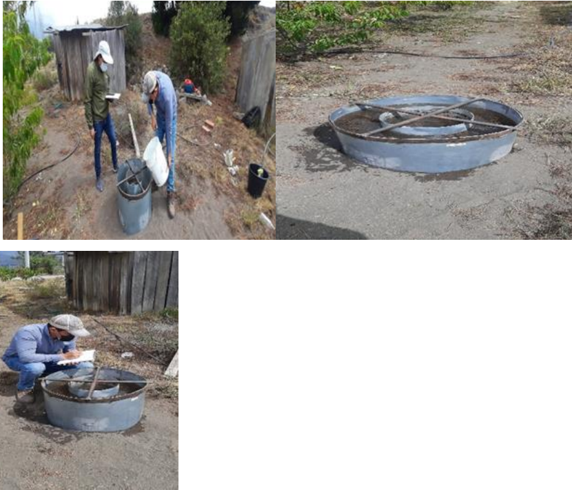
Figura 4-3: Metodología para calcular la velocidad básica de infiltración
