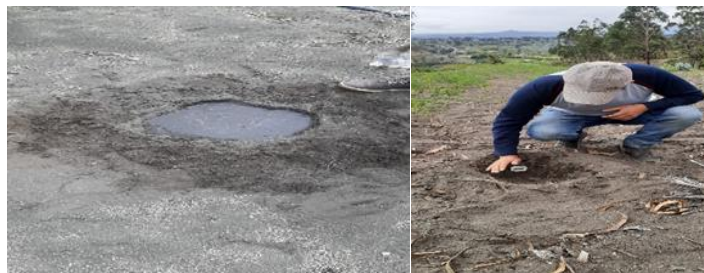
Figura 3-3: Metodología para determinar densidad aparente
