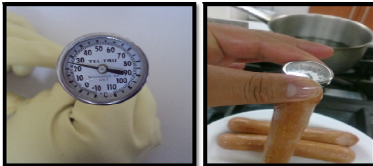
FOTOGRAFIA No. 8. TERMÓMETRO MANUAL USADO PARA TOMAR LA TEMPERATURA AL CENTRO DEL PRODUCTO.
