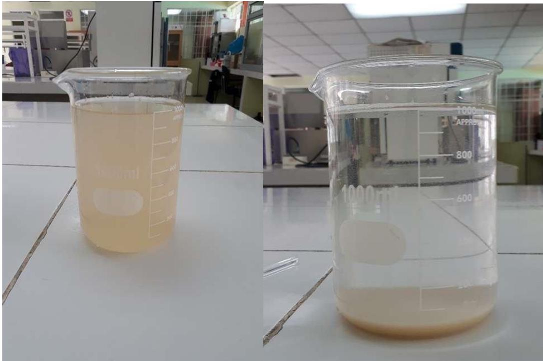
**E1. Coagulación y floculación en una muestra de agua cruda**
