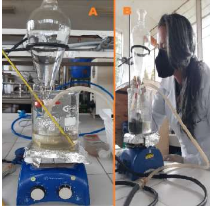
Figura 5-2. A. Equipo para síntesis de M sobre fibra de FA. B. Control de temperatura y revoluciones.
