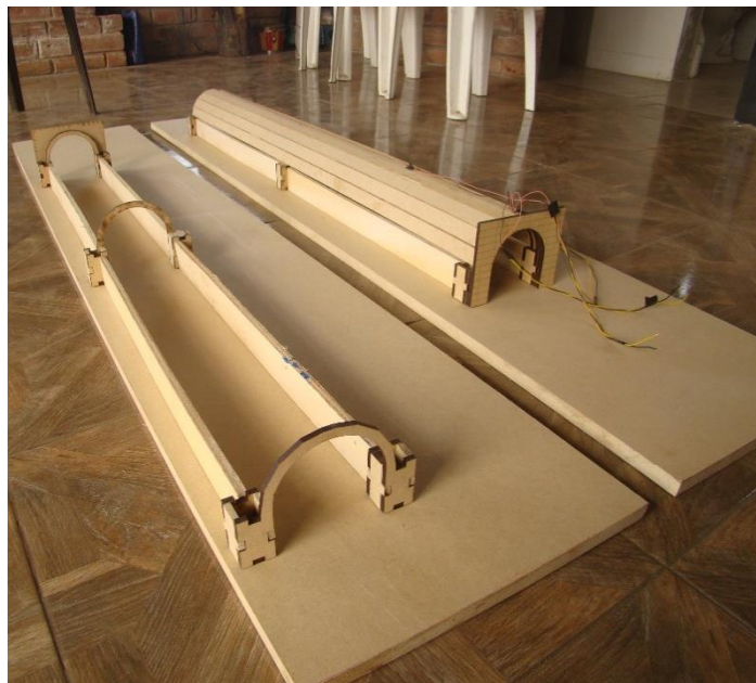
Figura 42-3. Resultado final de unión de bases de los túneles. Realizado por: López, 2020
