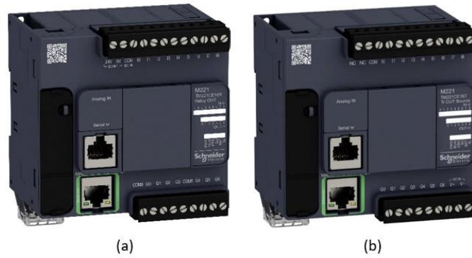
Figura 16-3. (a) PLC's Schneider TM221CE16R y (b) TM221CE16T Realizado por: López,2020
