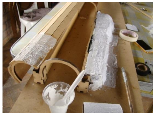
Figura 80-3. Relleno de Papel para formado.
