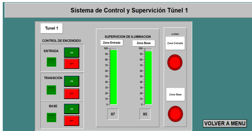
Figura 85-4. Ventana de control y supervisión.
