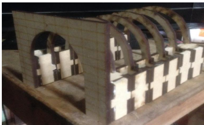
Figura 37-3. Piezas base inferiores pegadas.
