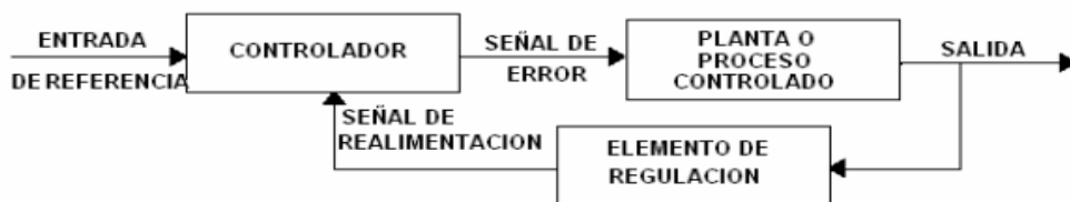
Figura 3-1. Sistema de control de lazo cerrado
