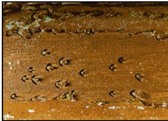
Figura 1.12 Efectos de la erosión-corrosión
