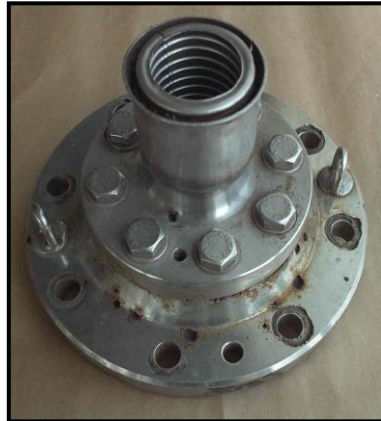
Figura 1.9 Corrosión por fisura (crevice)
