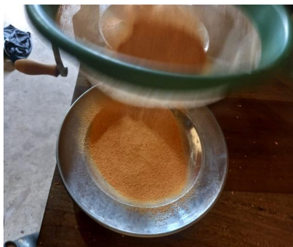
Figura 2-2. Tamizado de Zanahoria Molida
