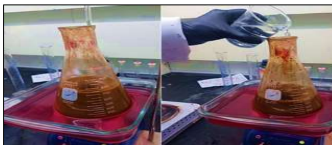
Ilustración 3-4: Agregado de agua destilada. A) 150 ml de agua destilada gota a gota. B) 500 ml de agua destilada.
