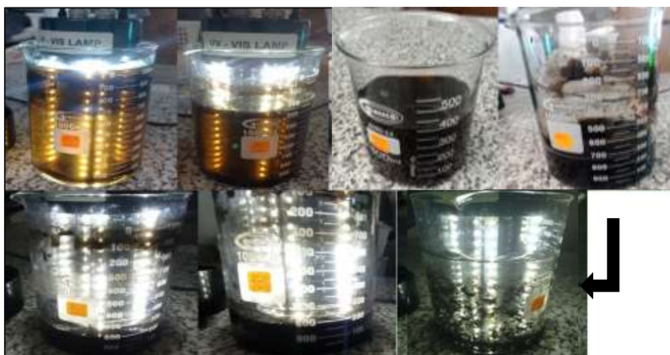
Ilustración 3-21: Irradiación luz visible a concentraciones de 0,16 mg/ml para cada longitud de onda 500nm y 700nm respectivamente.
