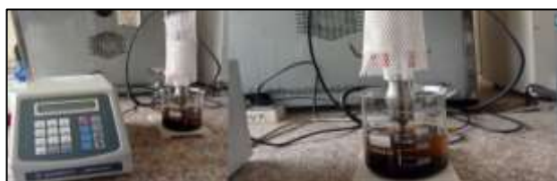
Ilustración 3-12: Sonicación por ultrasonido, a dos preparados de óxido de grafito.
