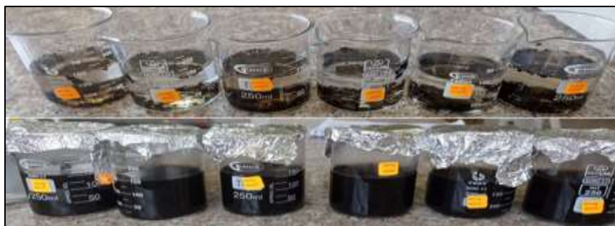
Ilustración 3-18: Concentraciones de GO, por proceso de sonicación por 35 minutos a temperatura ambiente.
