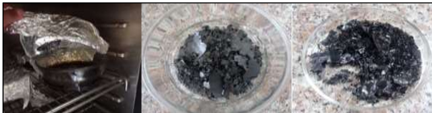
Ilustración 3-14: Secado de GO y trasladado a porta muestras para su posterior experimentación.
