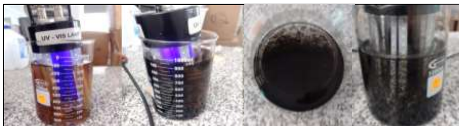
Ilustración 3-20: Irradiación luz ultravioleta a concentraciones de 0,16 mg/ml para cada longitud de onda 300nm y 350nm respectivamente.
