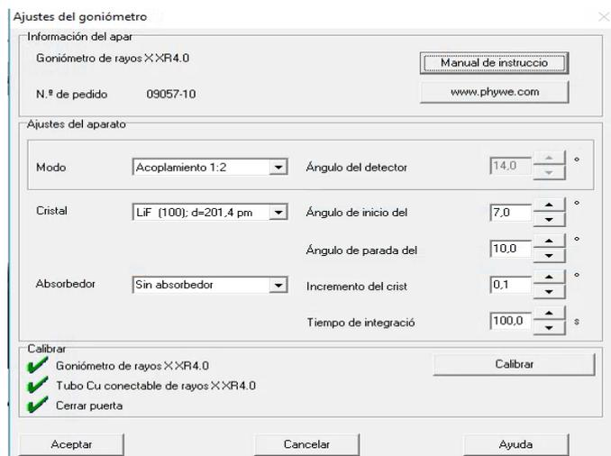
**Ilustración 2-6:** Interfaz del software Measure de Phywe
