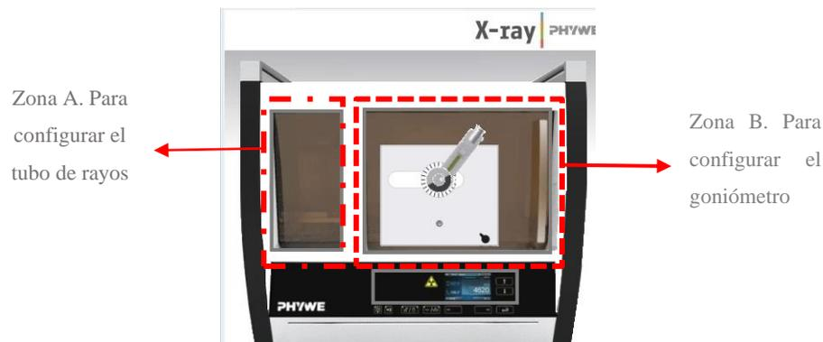
**Ilustración 2-9:** Interfaz del software Measure (unidad de rayos x)
