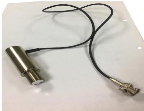
**Ilustración 2-7:** Tubo contador Geiger Müller
