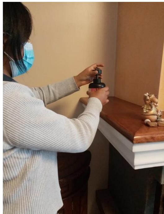
**Anexo 10-B:** Colocación del sistema de detección SST-EPERM.
