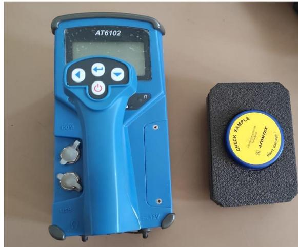
**Ilustración 12-2:** ATOMTEX y material para calibrar el equipo.
