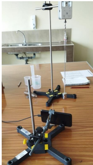
Ilustración 5-3: Sistema amortiguado armado
