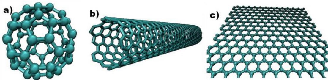
**Ilustración 5-1:** Configuraciones del carbono (variantes del grafeno) (a) Fullerenos (b) Nanotubo de Carbono (c) Grafeno.
