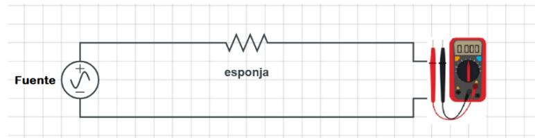
**Ilustración 6-2:** Circuito guía para la medición del voltaje efectivo de la esponja.
