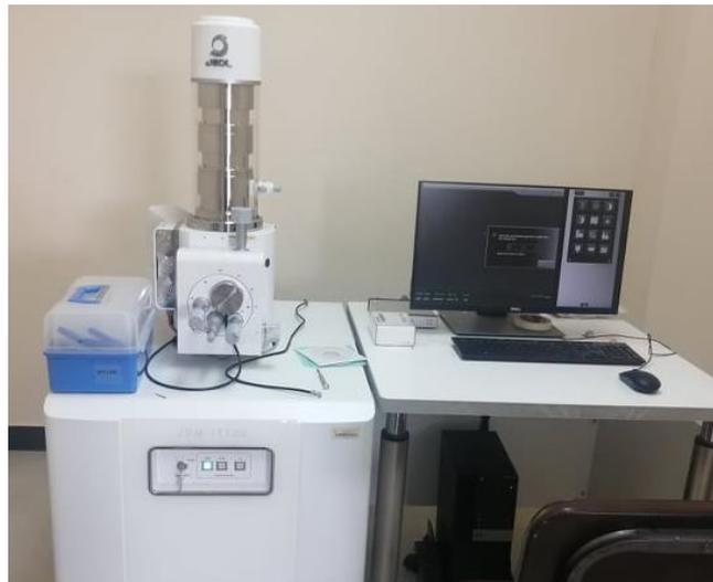
**Figura 13-2.** Microscopio electrónico de barrido
