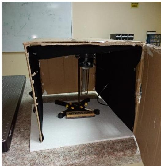
**Figura 22-2.** Montaje de la caja negra para la exposición UV
