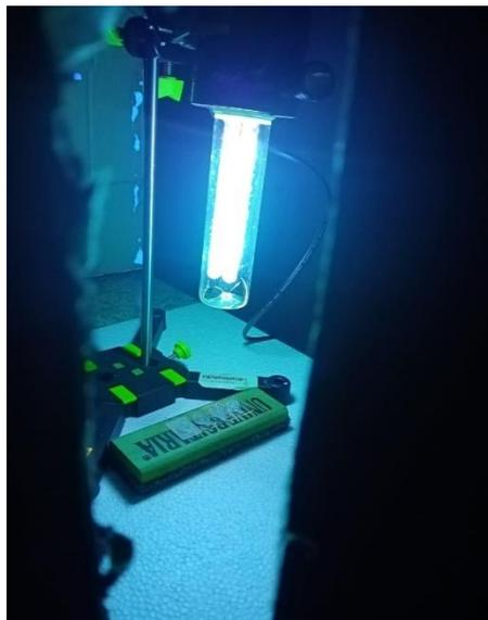
**Figura 20-2.** Exposición UV de las muestras dentro de la caja negra
