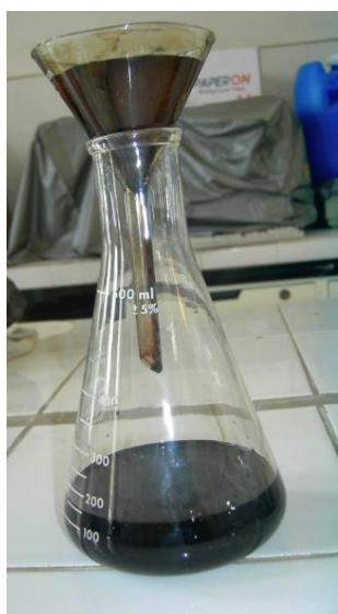
Fotografía 2.9.1.3- 2 Filtración del extracto gálico.
