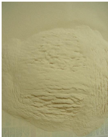
Fotografía 2.7- 2 Harina de guarango generada durante el tamizaje con tamaño de partícula de 0,106 mm.
