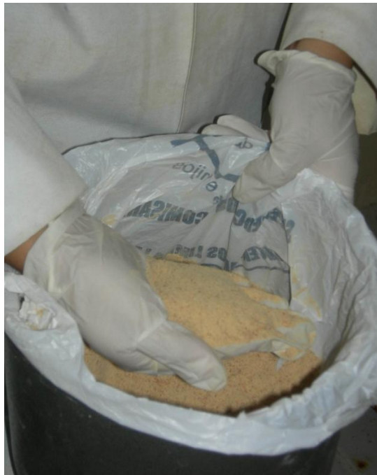
Fotografía 2.6- 2 Harina de guarango generada durante la molienda en el molino de impacto.
