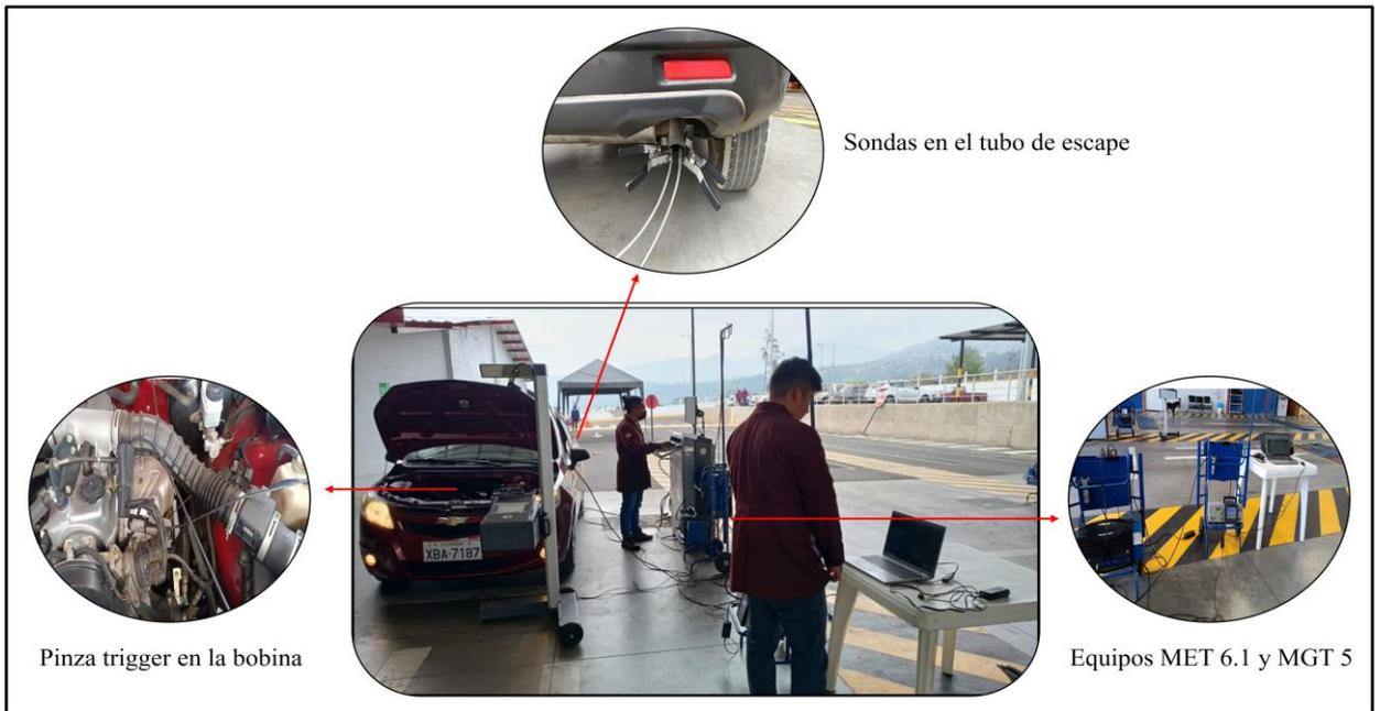
**Ilustración 3-11:** Esquema de cómo fue realizado las conexiones de los equipos.
