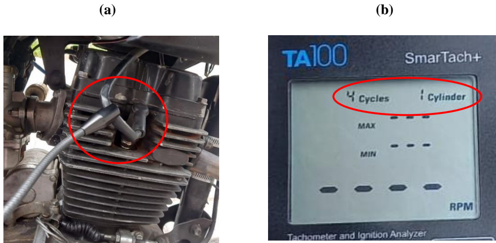
Ilustración 3-23: (a) Conexión del sensor al cable de la bujía; (b) Configuración del número de ciclos y cilindros
