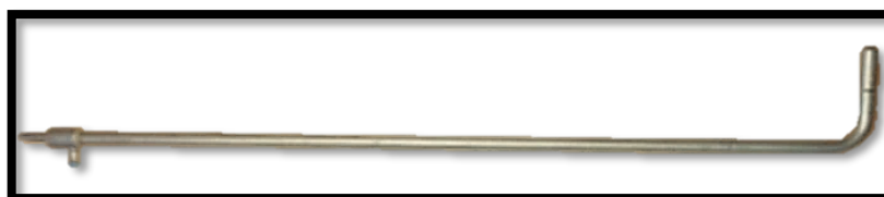
Ilustración 3-9: Tubo Pitot Prandtl o curvado
