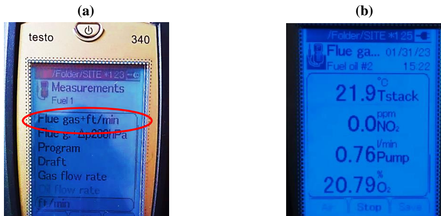
Ilustración 3-13: (a) Opción del menú de mediciones “Flue gas + ft/min”, (b) Proceso de medición de la temperatura y porcentaje de oxígeno
