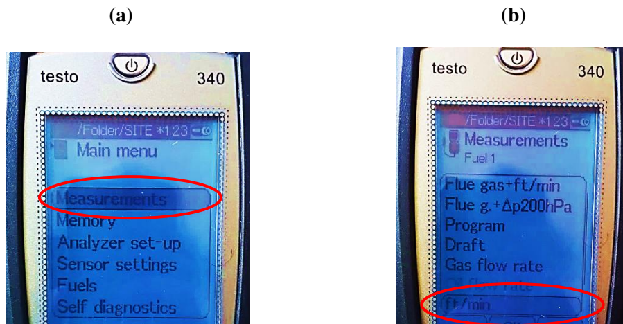
Ilustración 3-11: (a) Opción del menú principal “Mediciones”, (b) Opción del menú de mediciones “ft/min”
