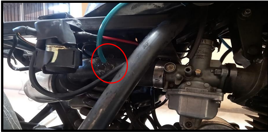
Ilustración 3-5: Instalación de la conexión del generador de hidrógeno en el múltiple de admisión
