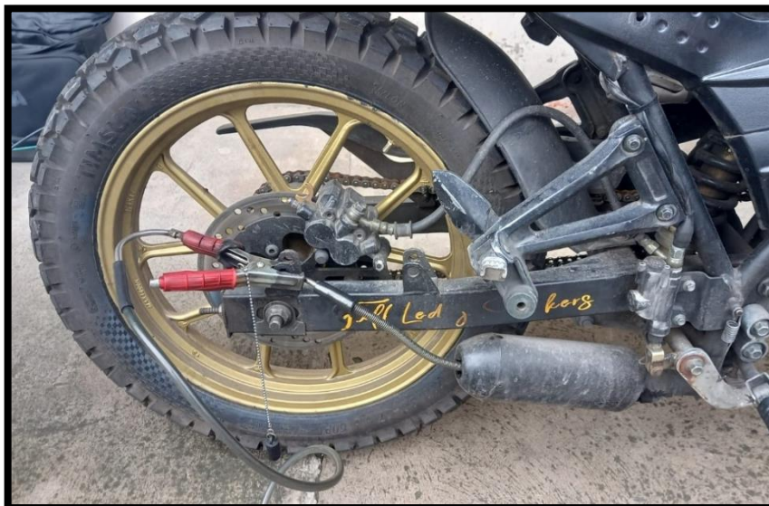
Ilustración 3-25: Conexión de la sonda en el tubo de escape
