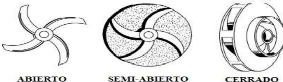
**Ilustración 2-3: Clasificación de impeler**
