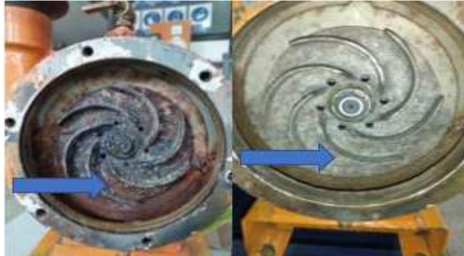
**Ilustración 4-3:** Resultado del impulsor de la bomba centrífuga
