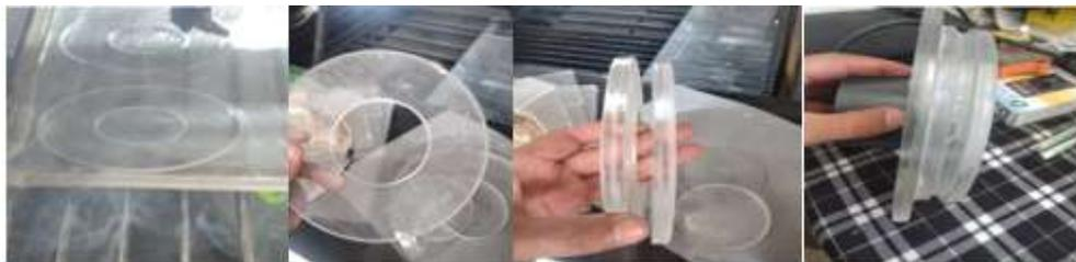
**Ilustración 3-17:** Construcción de tapa de acrílico para la bomba
