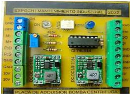
**Ilustración 3-30:** Placa de adquisición de datos
