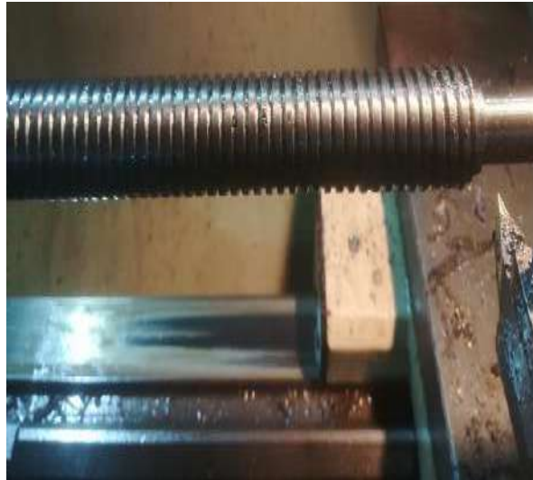
Ilustración 196-3: Mecanizado de tornillo de potencia mecanizado Realizado por: Aldas W. y Lalón C. 2023
