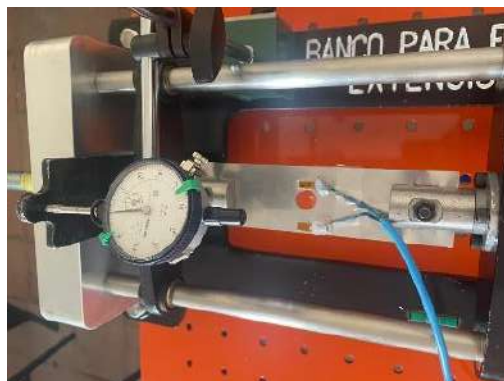
Ilustración 222-3: Montaje de probeta con agujero transversal Realizado por: Aldas W. y Lalón C. 2023
