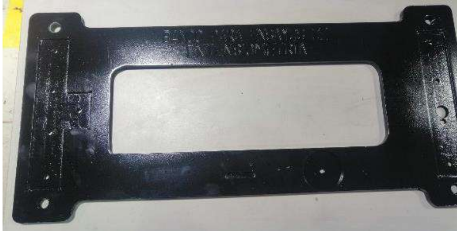
Ilustración 189-3: Placa base, cortada con plasma y contorneada en CNC Realizado por: Aldas W. y Lalón C. 2023
