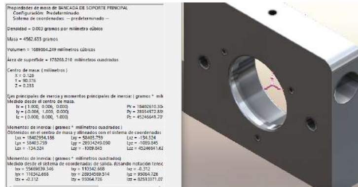
Ilustración 25-3: Propiedades de masa de bancada de soporte Fuente: (DASSAULT SYSTEMS 2015).
