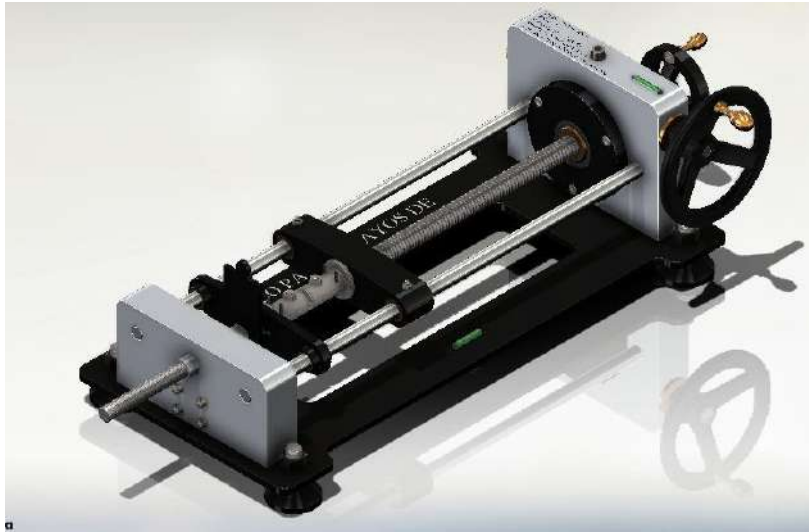
Ilustración 209-3: Banco de carga axial para extensimetría Realizado por: Aldas W. y Lalón C. 2023
