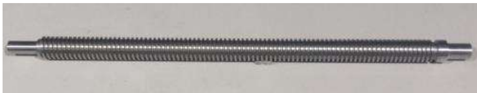
Ilustración 195-3: Tornillo de potencia mecanizado Realizado por: Aldas W. y Lalón C. 2023
