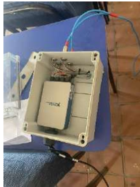
Ilustración 221-3: Conexión del adquisidor de datos Realizado por: Aldas W. y Lalón C. 2023
