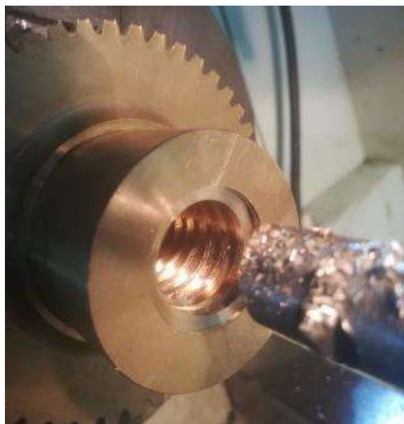
Ilustración 194-3: Mecanizado rosca trapecial interna en la corona Realizado por: Aldas W. y Lalón C. 2023
