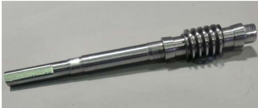
Ilustración 196-3: Mecanizado con buril de sin fin Realizado por: Aldas W. y Lalón C. 2023
