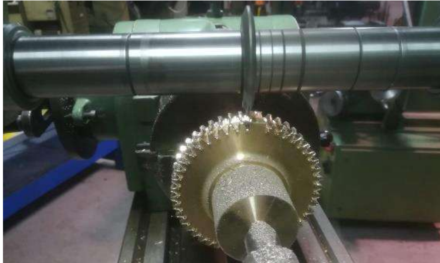
Ilustración 193-3: Mecanizado 46 dientes en la corona Realizado por: Aldas W. y Lalón C. 2023
