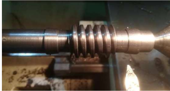
Ilustración 195-3: Tornillo sin fin mecanizado Realizado por: Aldas W. y Lalón C. 2023
