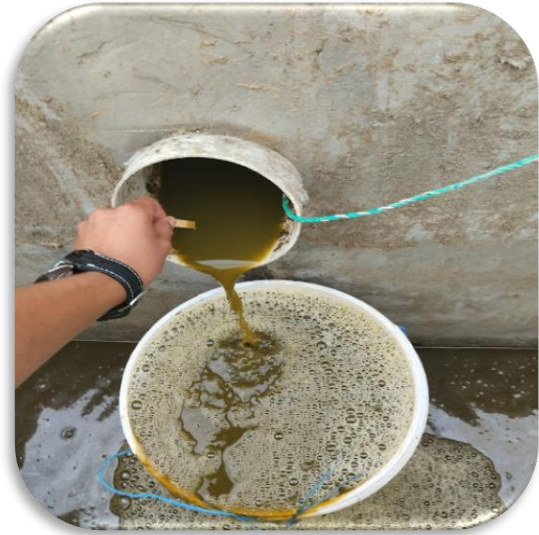
Ilustración 17-3: Toma de datos de PH caja de entrada a la izquierda y caja de salida a la derecha.
