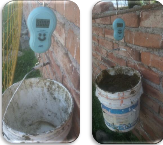
Ilustración 16-3: De izquierda a derecha balanza sin estiércol y balanza con estiércol
