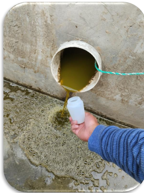
Ilustración 21-3: Toma de muestra de biól para análisis químico.
