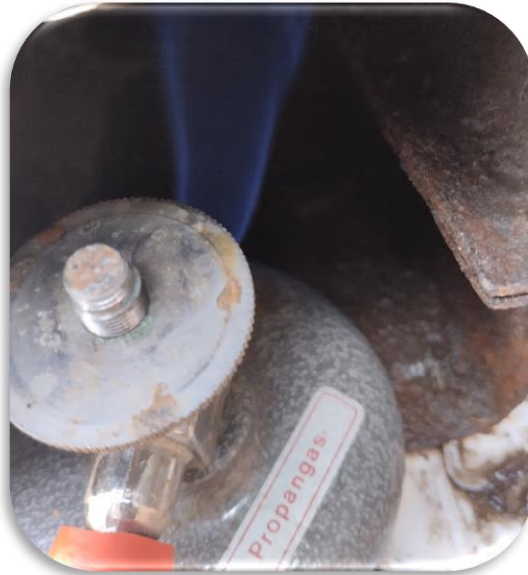
Ilustración 19-3: Prueba de flameado de biogás.
