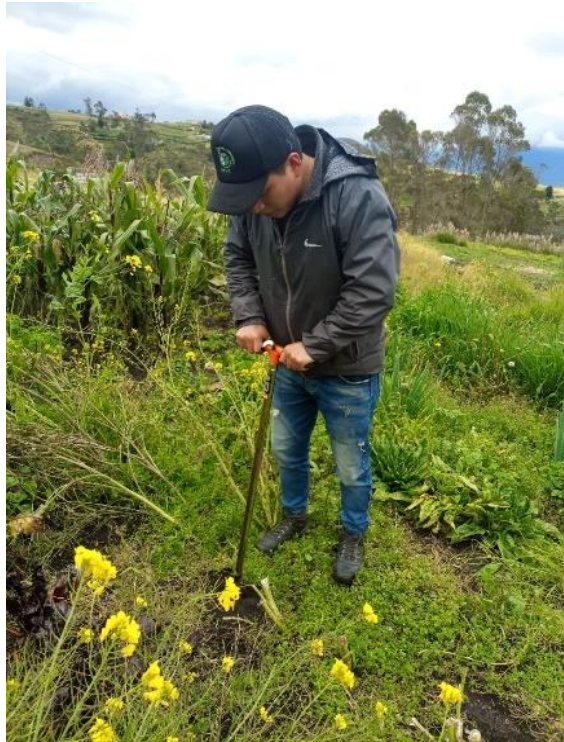
Ilustración 4-3. Toma de muestras de suelos
