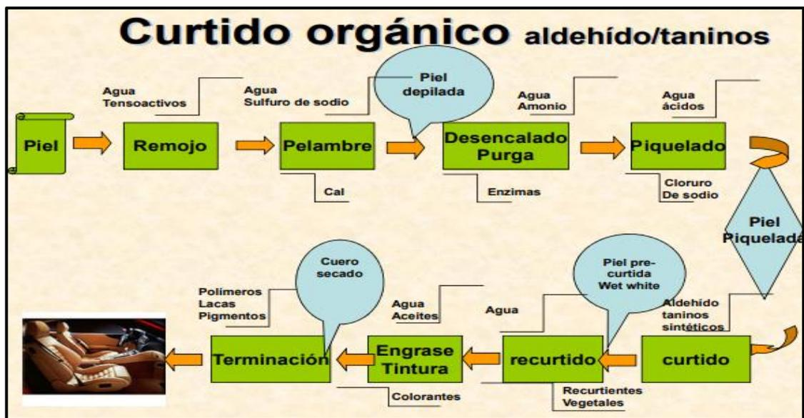
**Ilustración 2-1:** Diagrama de flujo de la producción de cuero libre de cromo para tapicería automotriz.
