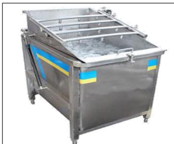
**Ilustración 4-5:** Lavadora para caña de azúcar
