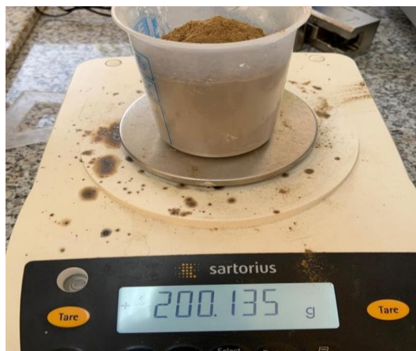
Ilustración 18-3: Peso de muestra mineral.
