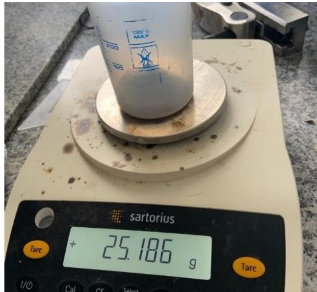
Ilustración 16-3: Peso de muestra mineral.
