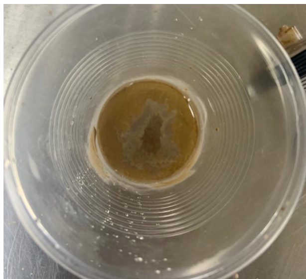
Ilustración 41-3: Cambio de coloración en muestra con \text{AgNO}_3 , en 44 horas de lixiviación.
