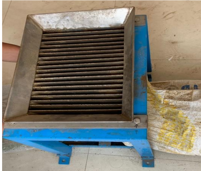
Ilustración 11-3: Obtención de muestra representativa utilizando cuarteador de rifles.
