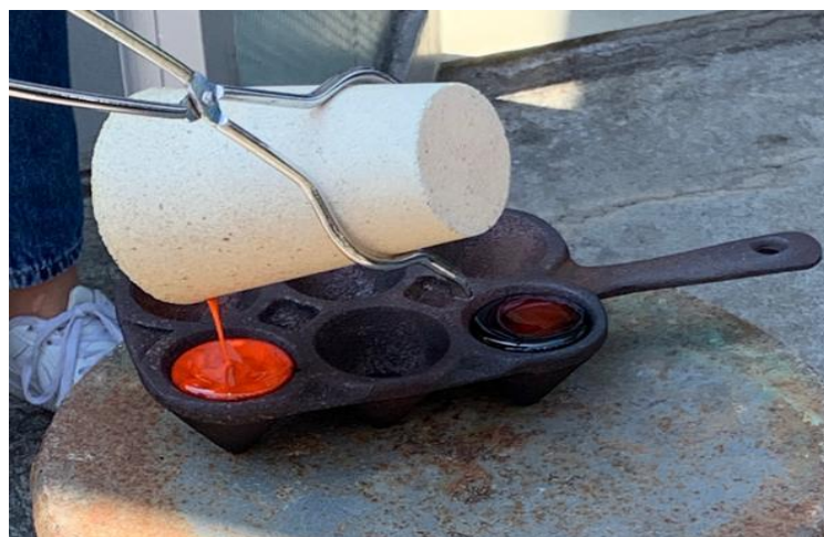
Ilustración 13-3: Colocación de muestra fundida en payonera.
