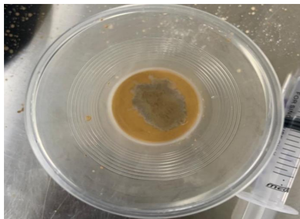
Ilustración 24-3: Cambio de coloración debido a la colocación de nitrato de plata.
