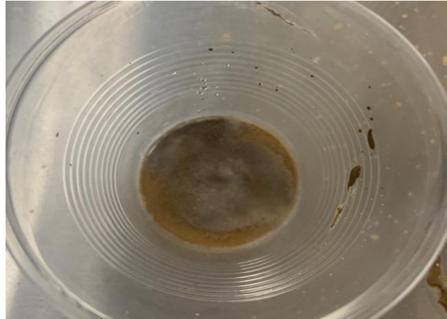
Ilustración 29-3: Medida de concentración de cianuro, con adición de nitrato de plata.
