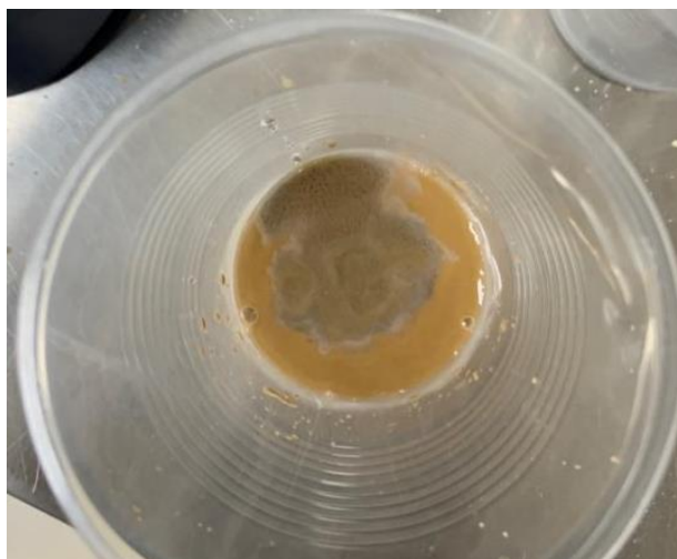
Ilustración 37-3: Cambio de coloración debido a la adición de nitrato de plata.
