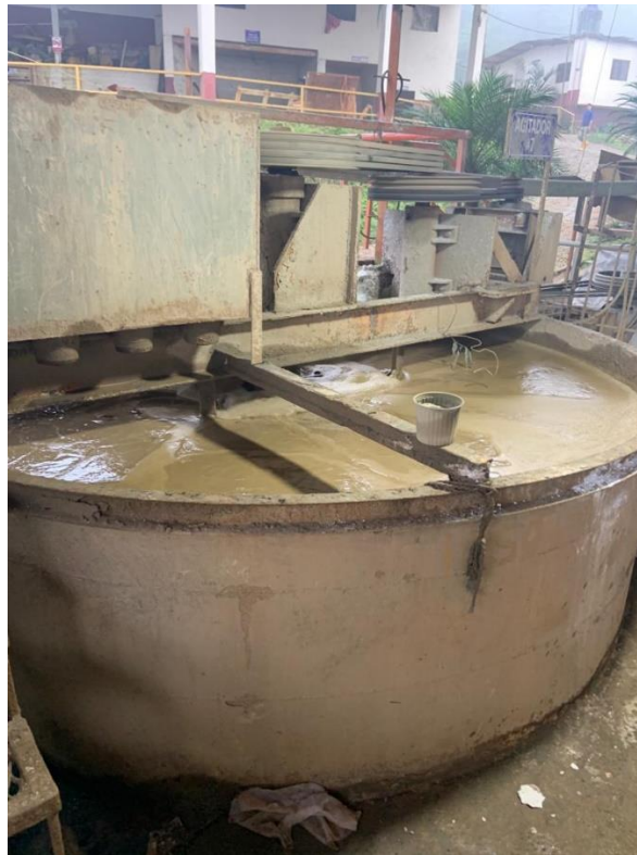
Ilustración 6-3: Proceso de agitación de pulpa.
