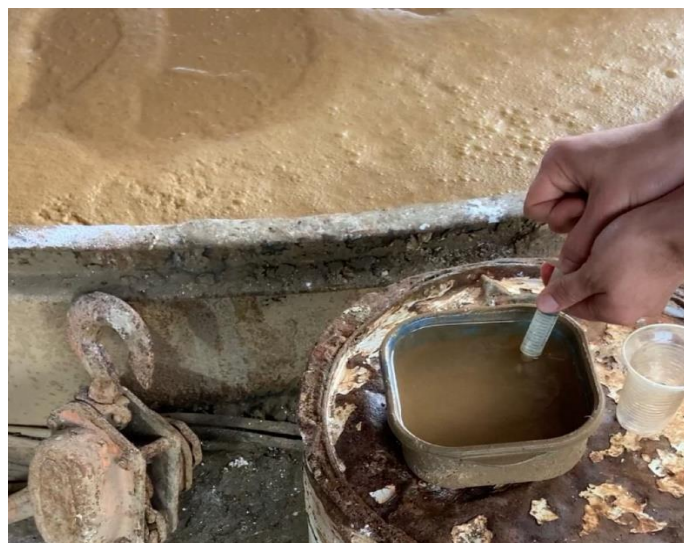
Ilustración 8-3: Toma de muestra para medida de fuerza del cianuro.
