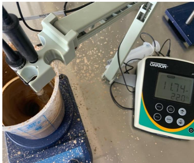
Ilustración 28-3: Disminución mínima de pH en lixiviación con cianuro.
