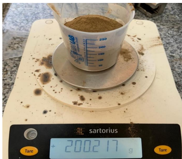
Ilustración 30-3: Peso de muestra mineral para lixiviación con GDA.
