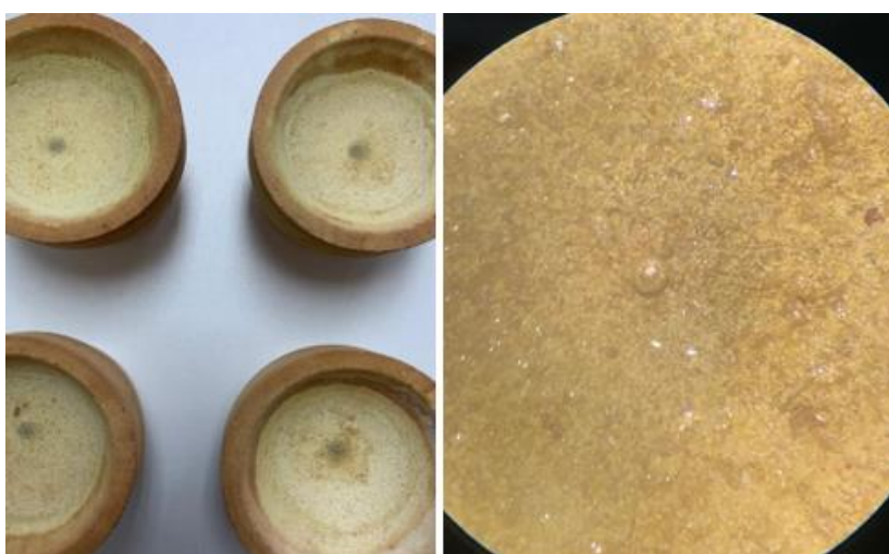
Ilustración 14-3: botones doré obtenidos en copelación.
