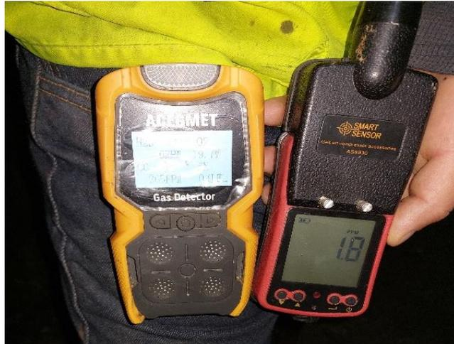
**Ilustración 9-4:** Multidetector de gases ACEGMET y detector de NO<sub>2</sub> AS8906
