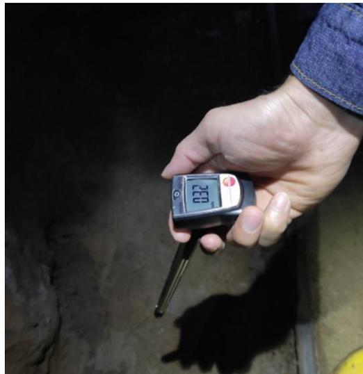
**Ilustración 2-4:** Medición de velocidad del aire.
