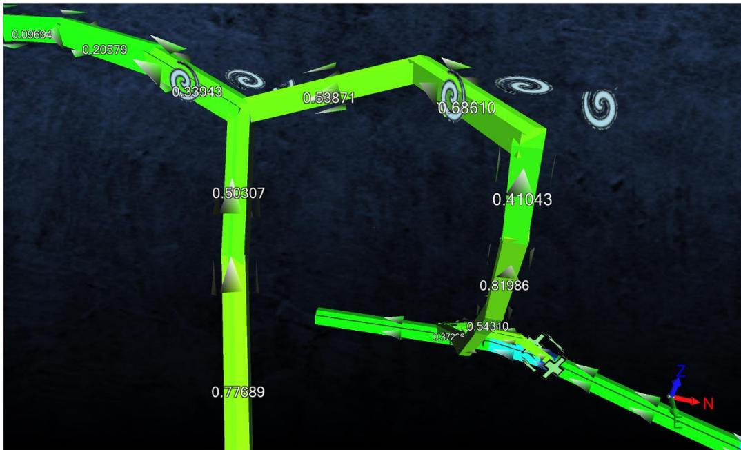
**Ilustración 21-4:** Perdidas por choque por cambios bruscos de dirección.
