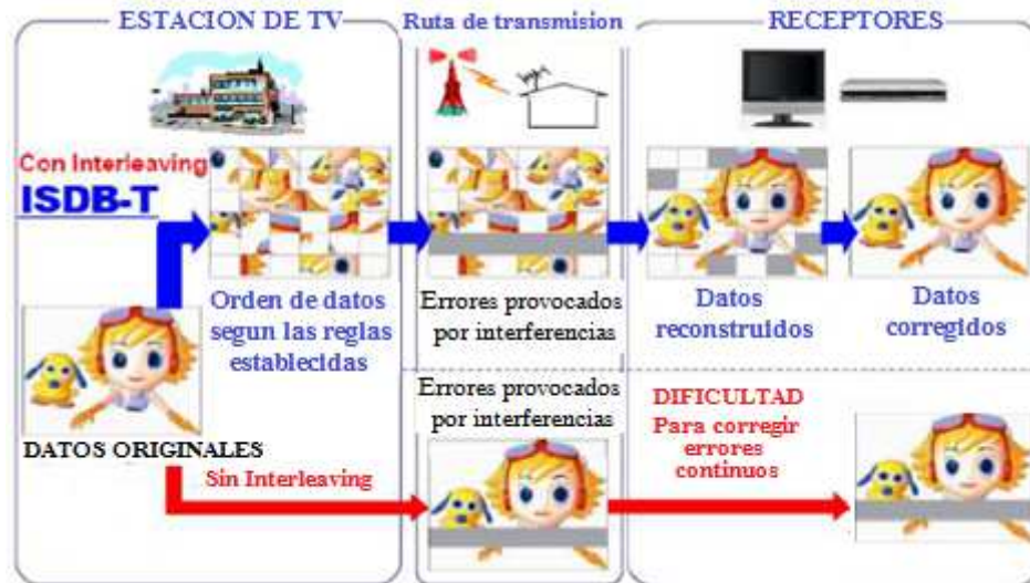
Fig.III. 3 Sistema ISDB-Tb con interleaving 3
